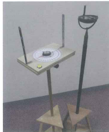
左はNPO「考える会」考案の杖先方位盤。右は明治時代製と思われる杖先方位盤。彎窠羅鍼 わんからしん と呼ばれる。
